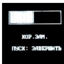
Рис 5. Наличие дефекта катушки, уложенной в пазы.
